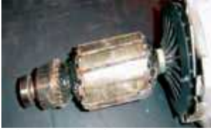
Kiéggett armatúra (túlterhelés)
