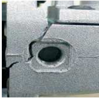
A burkolat törése, leejtés miatt
