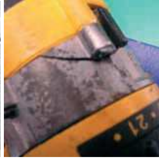
Repedések a leejtett készüléken
