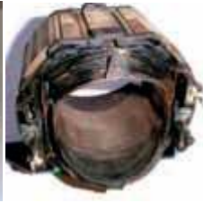
Megolvadt végdarab - túlterhelés
