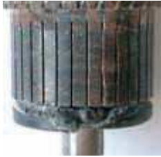
Megolvadt végdarab - túlterhelés
